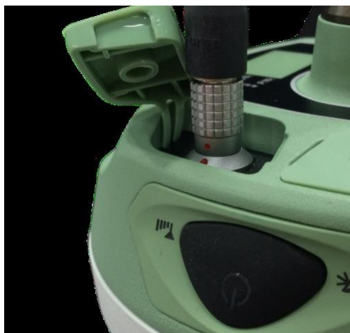
Podłączony kabel do Lemo
